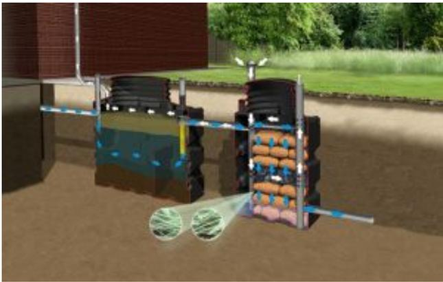
Abbildung: Kompaktanlage (Vorklärung - Bioreaktor)
